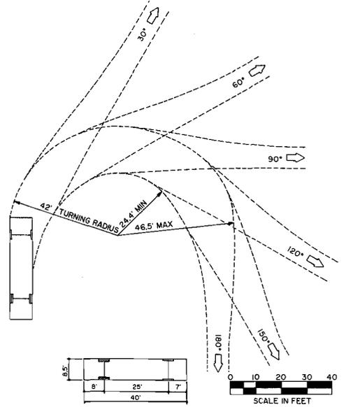
D. 50-FOOT-LONG INTERMEDIATE SIZE SEMITRAILER COMBINATION TRUCK
